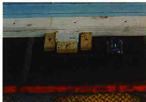
衝撃計測器のコンテナ床面への設置例
