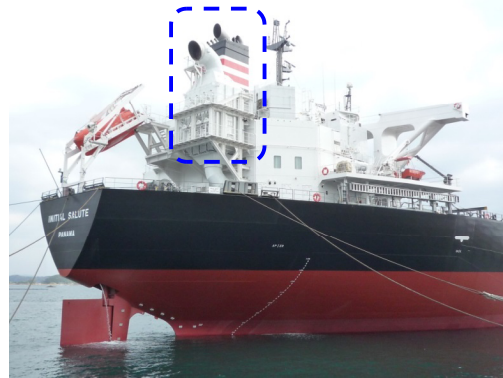
SCRを試験搭載した、INITIAL SALUTE
