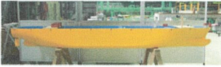
LNG carrier model (L=4.0m)
