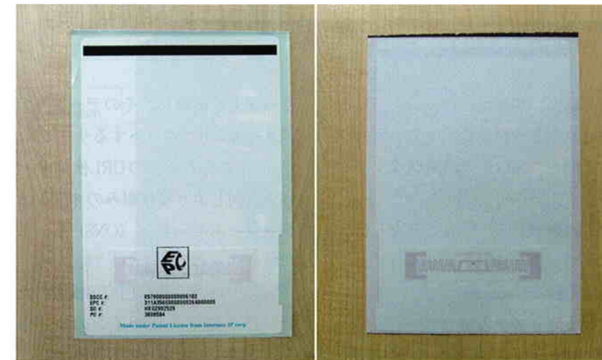
写真1、2 凸版印刷のGen2ラベルタグ（4×2インチ）
