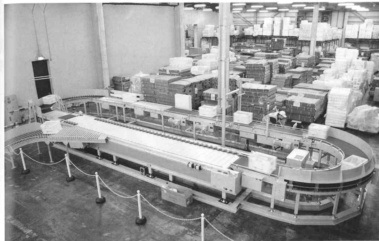
写真-1 MTIのRFIDラボに設置された高速仕分けコンベヤラインとリーダーライタ
