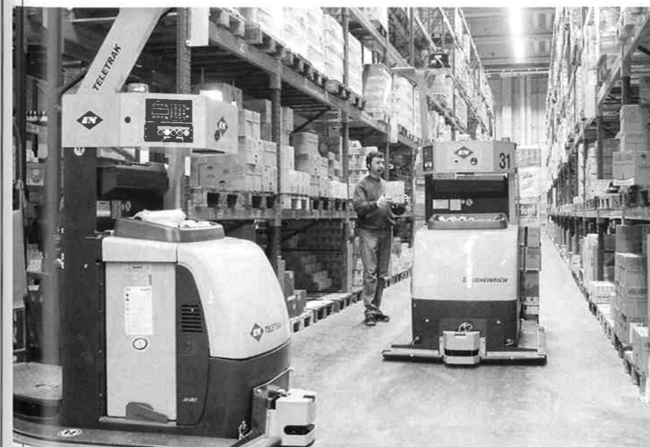
▲音声ガイドと作業者に伴走するAGVを組合せた“Pick-n-Go”™ピッキングシステム
