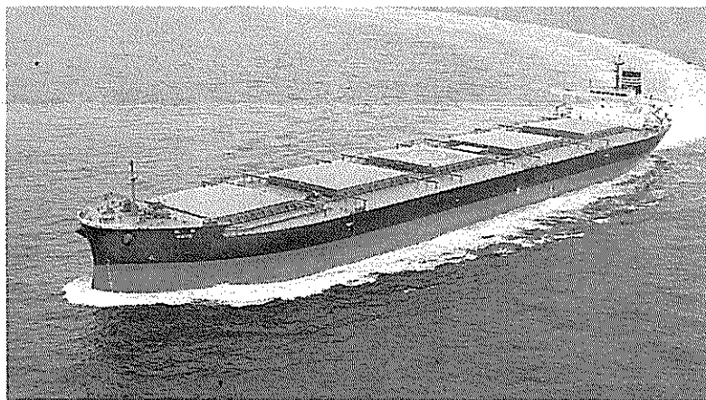
選定された「SOYO(双洋)」。主機掃気を利用した空気潤滑システムの装備が評価された
