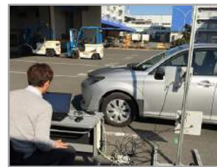
RFID貼付場所と読み取り率確認テスト風景
