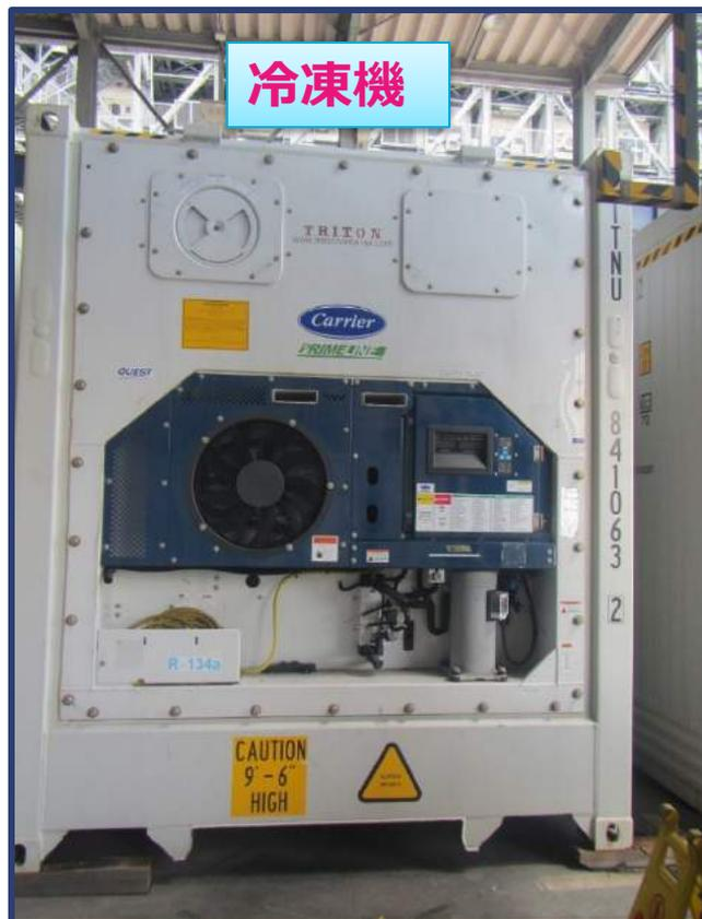
**庫内温度制御**： $-30^{\circ}\text{C} \sim +30^{\circ}\text{C}$  (0.1 $^{\circ}\text{C}$ 単位)
