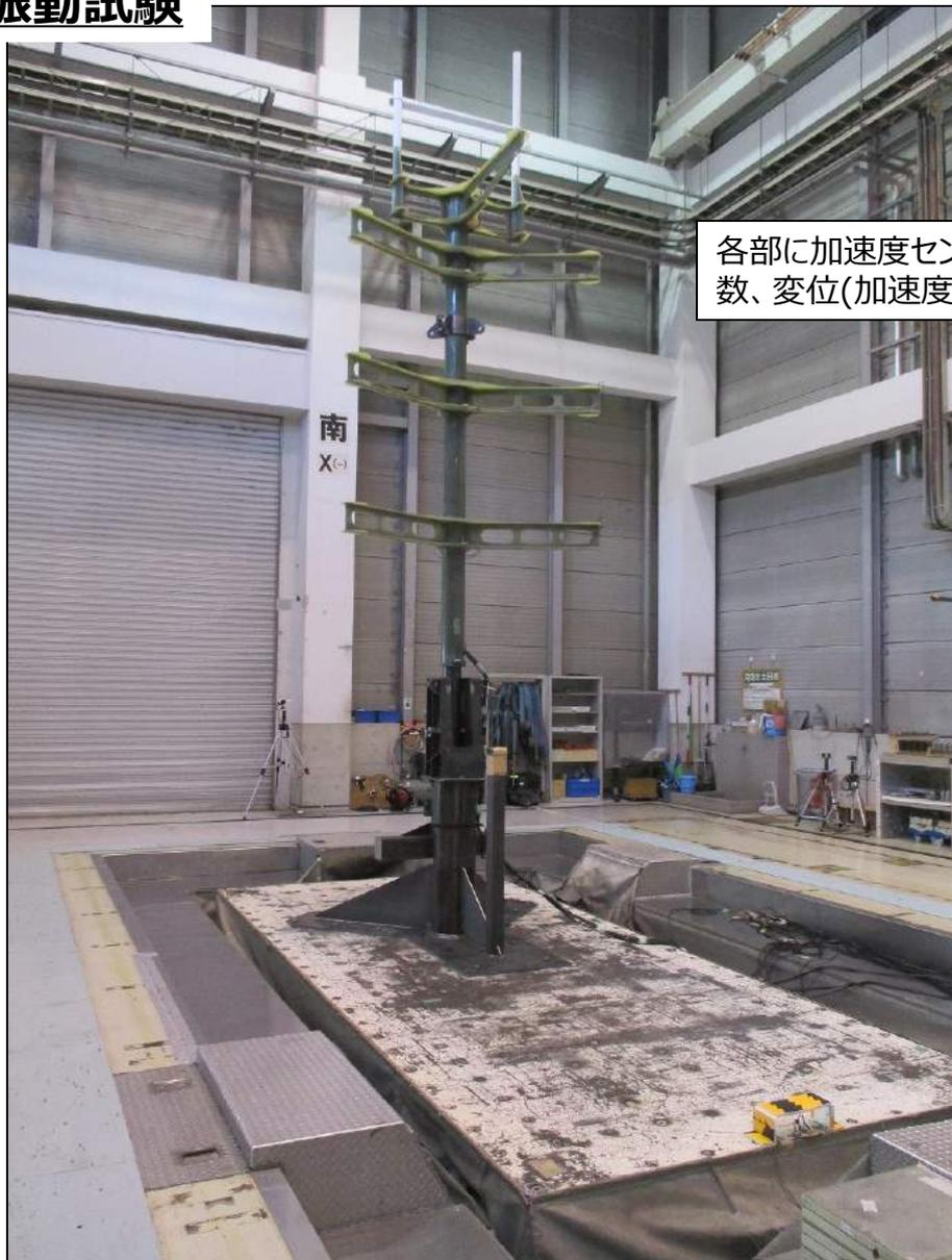
各部に加速度センサーを取付け、固有振動数、変位(加速度値より換算)を計測
