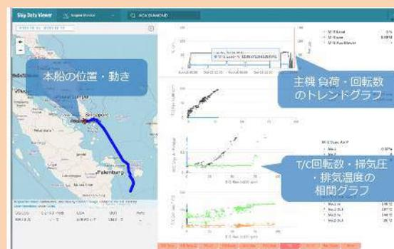
実証実験で取得した高粒度の船舶IoTデータを、ShipDCのAPIから自動取得し可視化するWEBビューアアプリを開発
