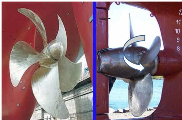
固定ピッチプロペラ(FPP) 可変ピッチプロペラ(CPP)
