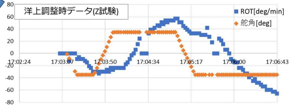
水槽試験、風洞試験、洋上試験データに基づいて船体運動モデルの開発・修正を実施
