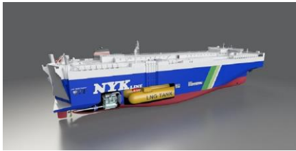
LNG DF Battery Hybrid PCTC
