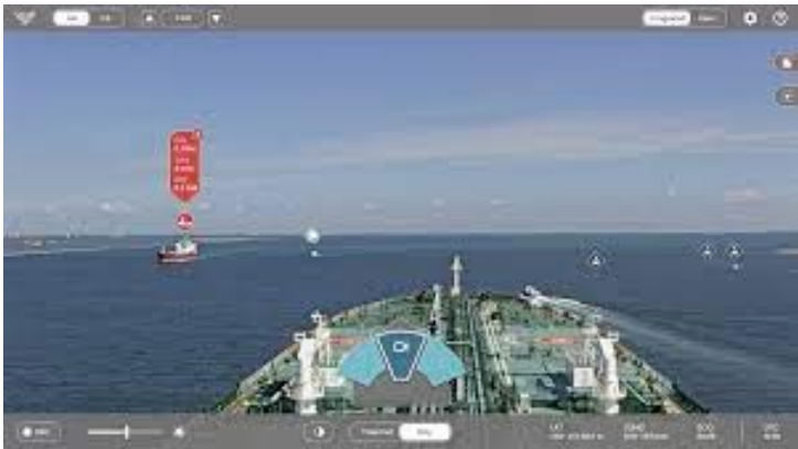
画像認識による他船検知・見張りシステムの例 (ORCA AI)
