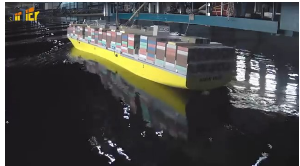
水槽試験の映像(MARIN TopTier JIP)
